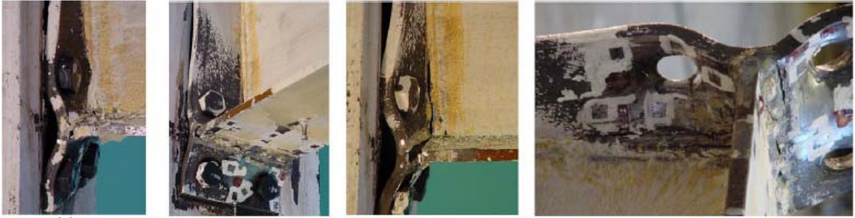
Figura 4.2 Ilustración de la deformación de la palca extremo (Guirão y otros, 2004)
