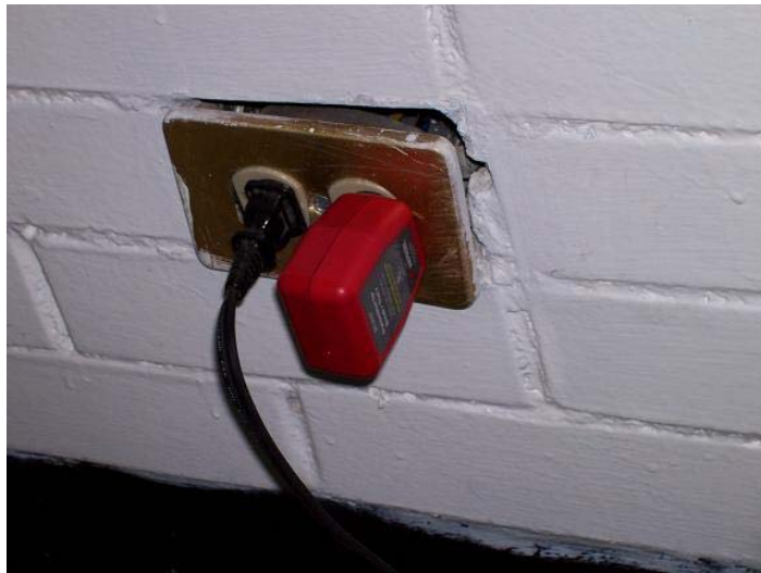
Figura 3.5 Emisor del trazador de corrientes
