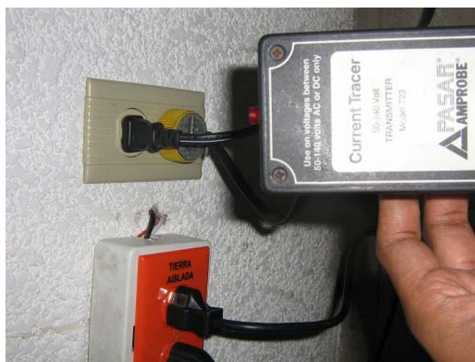
Figura 3.3 Emisor del trazador de corrientes
