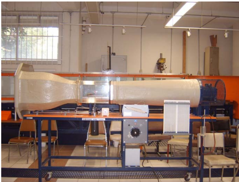
Figura 4. Fotografía del túnel de viento ( subsonic wind tunnel; Armfield Technical education ), en el Laboratorio de Hidráulica (Instituto de Ingeniería, UNAM).
