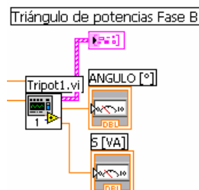
Figura 3.41 Vista del Sub VI para el trazo del triángulo de potencias por fase.
