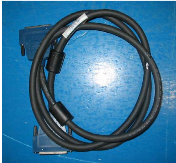
Figura 3.14 Cable de comunicación entre el módulo de conexiones y la tarjeta de adquisición de datos.
