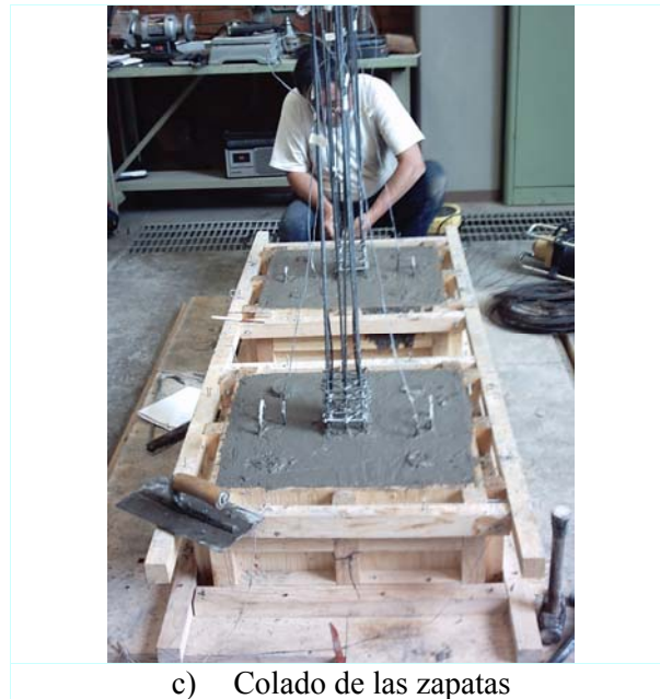
Fig. 3.26. Aspectos del proceso constructivo del espécimen (continuación)
