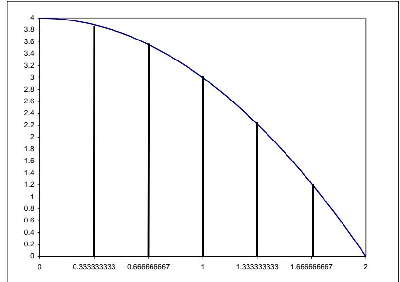
$$M_x = \left(\frac{1}{2}\right)\left(\frac{1}{3}\right)\left(\frac{1}{3}\right)\left[4-0^2\right]^2+4\left\{\left(4-\left(\frac{1}{3}\right)^2\right)^2+\left(4-\left(\frac{3}{3}\right)^2\right)^2+\left(4-\left(\frac{5}{3}\right)^2\right)^2\right\}+2\left\{\left(4-\left(\frac{2}{3}\right)^2\right)^2+\left(4-\left(\frac{4}{3}\right)^2\right)^2\right\}+4-\left(\frac{6}{3}\right)^2\left[\right]$$
