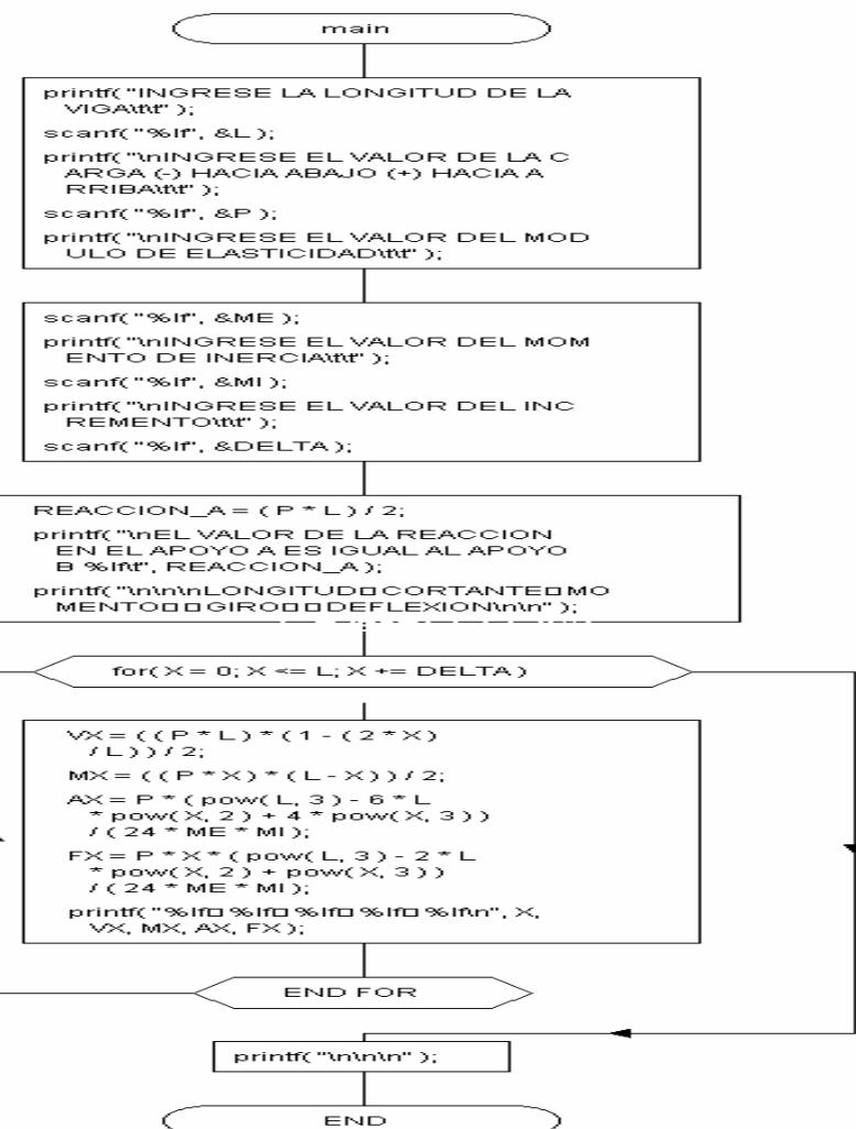
ESTE PROGRAMA PERMITE CONOCER LAS REACCIONES EN LOS APOYOS, LOS CORTANTES, MOMENTOS FLECTORES, ÁNGULOS DE GIRO Y LAS DEFLEXIONES DE UNA VIGA SIMPLEMENTE APOYADA CON CARGA CONCENTRADA EN EL CENTRO.
