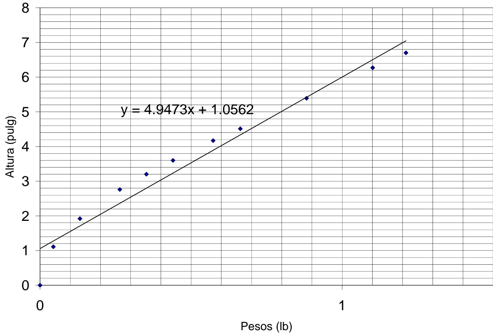
Experimentalmente se han obtenido las deformaciones de un resorte para diferentes cargas, los datos se proporcionan en tabla siguiente.
