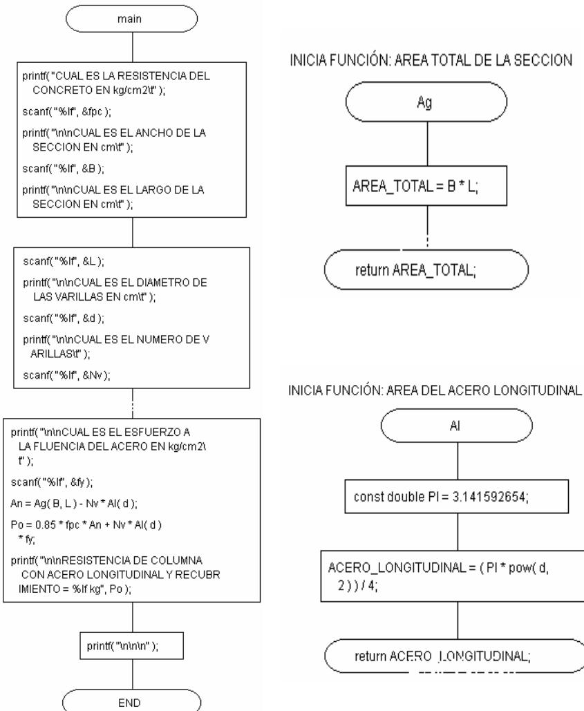
ESTE PROGRAMA PERMITE CONOCER LA RESISTENCIA DE UNA COLUMNA CORTA SUJETA A COMPRESIÓN AXIAL DE FORMA CIRCULAR, CON REFUERZO HELICOIDAL SIN RECUBRIMIENTO, NTC-2001
