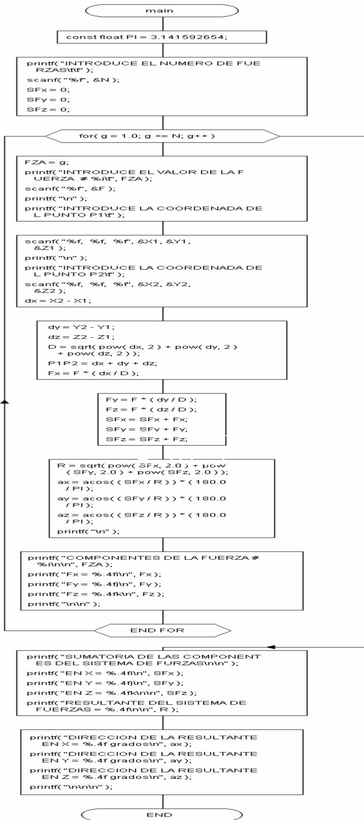
ESTE PROGRAMA PERMITE DETERMINAR LA RESULTANTE DE UN SISTEMA DE FUERZAS CONCURRENTES EN EL PLANO, CUANDO SE CONOCEN AL MENOS DOS COORDENADAS DE LA LÍNEA DE ACCIÓN DE LAS FUERZAS, EJE VERTICAL (y) Y EJE HORIZONTAL (x)
