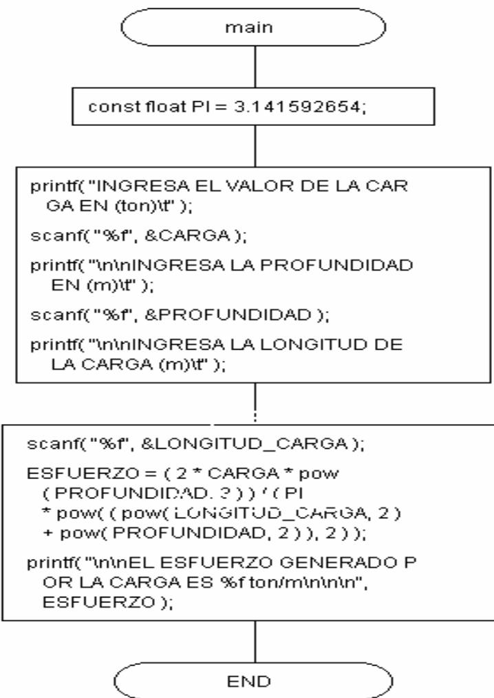
EN LA INGENIERÍA DE CIMENTACIONES, EL ESFUERZO VERTICAL QUE GENERA UNA CARGA PUNTUAL VERTICAL APLICADA EN LA SUPERFICIE SOBRE UNA MASA DE SUELO SEMIINFINITA, SE DETERMINA CON EL SIGUIENTE PROGRAMA. (MÉTODO DE BOUSSINESQ)
