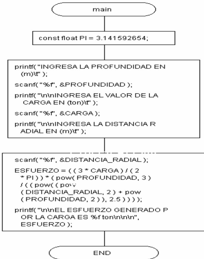
EN INGENIERÍA DE CIMENTACIONES, EL ESFUERZO VERTICAL QUE GENERA UNA CARGA UNIFORMEMENTE DISTRIBUIDA VERTICAL SOBRE UNA FRANJA INFINTA DE SUELO FLEXIBLE APLICADA EN LA SUPERFICIE, (MÉTODO BOUSSINESQ), SE DETERMINA CON ESTE PROGRAMA EJERCICIO #4) PROPUESTO POR FELIPE DE SANTIAGO MORA
