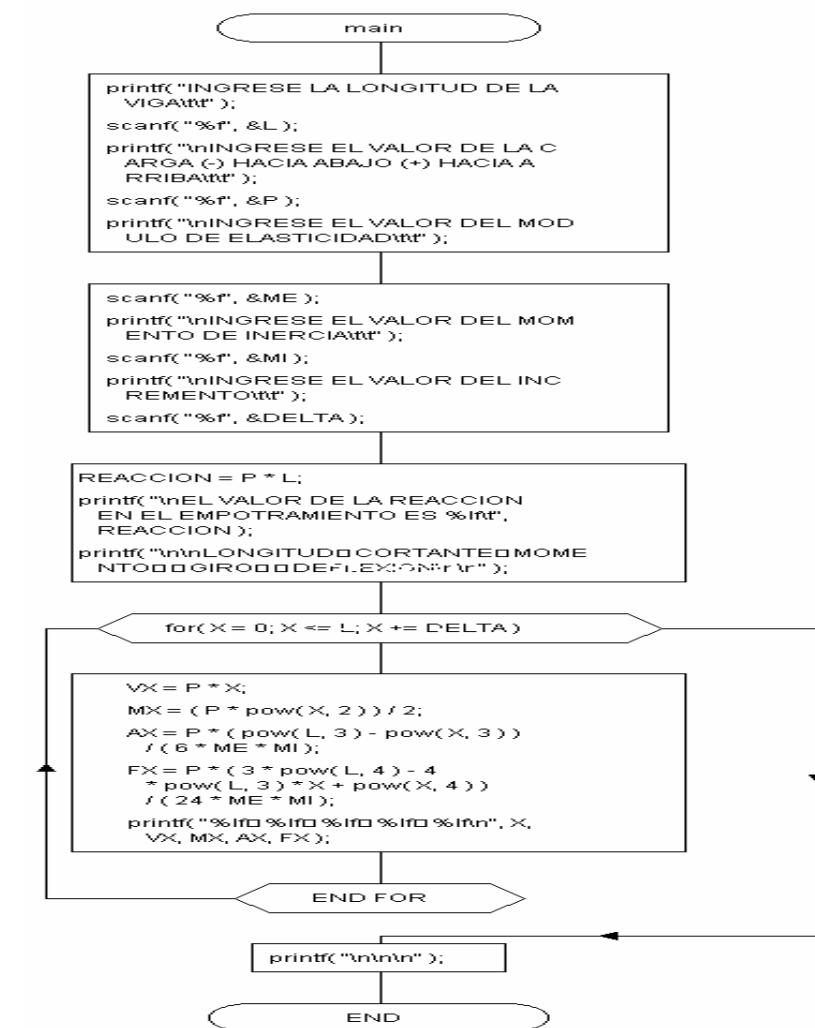
ESTE PROGRAMA PERMITE CONOCER LA REACCIÓN EN EL APOYO, LOS CORTANTES, MOMENTOS FLECTORES, ÁNGULOS DE GIRO Y LAS DEFLEXIONES DE UNA VIGA CANTILIVER CON CARGA CONCENTRADA EN EL EXTREMO LIBRE.
