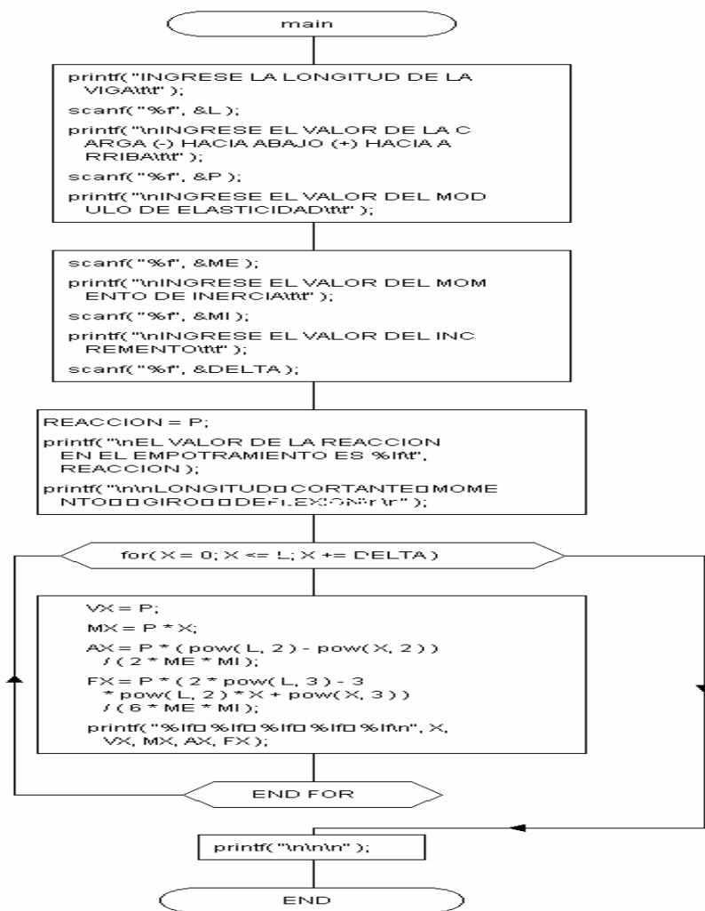
ESTE PROGRAMA PERMITE CONOCER LAS REACCIONES EN LOS APOYOS, LOS CORTANTES, MOMENTOS FLECTORES, ÁNGULOS DE GIRO Y LAS DEFLEXIONES DE UNA VIGA SIMPLEMENTE APOYADA CON CARGA UNIFORMEMENTE DISTRIBUIDA.
