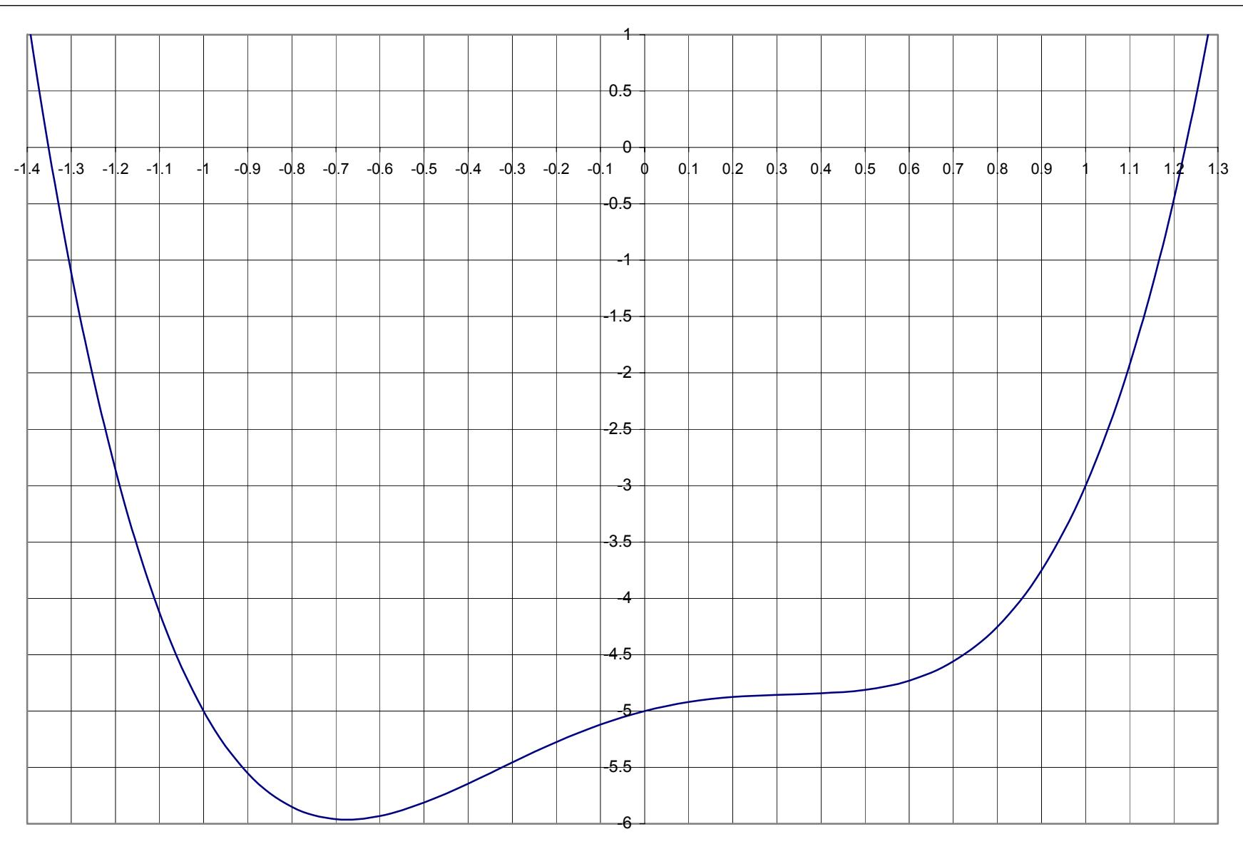
La cantidad de agua ( $Q$  = gasto pies cúbicos por segundo) que corre sobre un vertedero de  $B$  pies de ancho, está representada por la fórmula de Francis  $Q = 3.3(B - 0.2H)H^{3/2}$ , siendo  $H$  la altura del agua. Use el método de la secante para un intervalo de  $[1, 1.5]$  con un error de 0.0001%, para encontrar una aproximación a la raíz.
