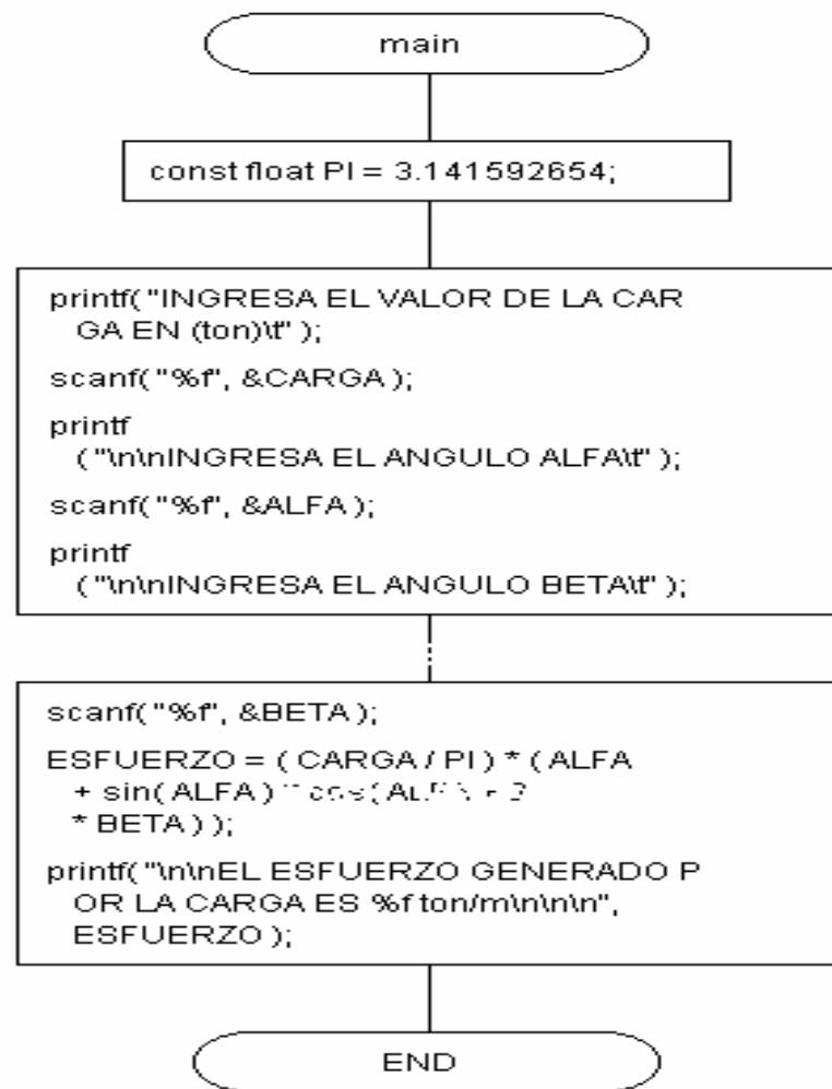
CONOCER LA RESISTENCIA DE ELEMENTOS CORTOS, DE CONCRETO SUJETOS A CARGA AXIAL DE COMPRESIÓN, ES MUY IMPORTANTE, ESTE PROGRAMA CALCULA LA RESISTENCIA DE UNA COLUMNA CORTA SIN ACERO DE REFUERZO (CONCRETO SIMPLE). NTC-2001
