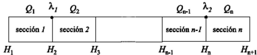
Fig. 4.3 Distribución de variables en el ducto con dos fugas en los límites de las secciones de los extremos
