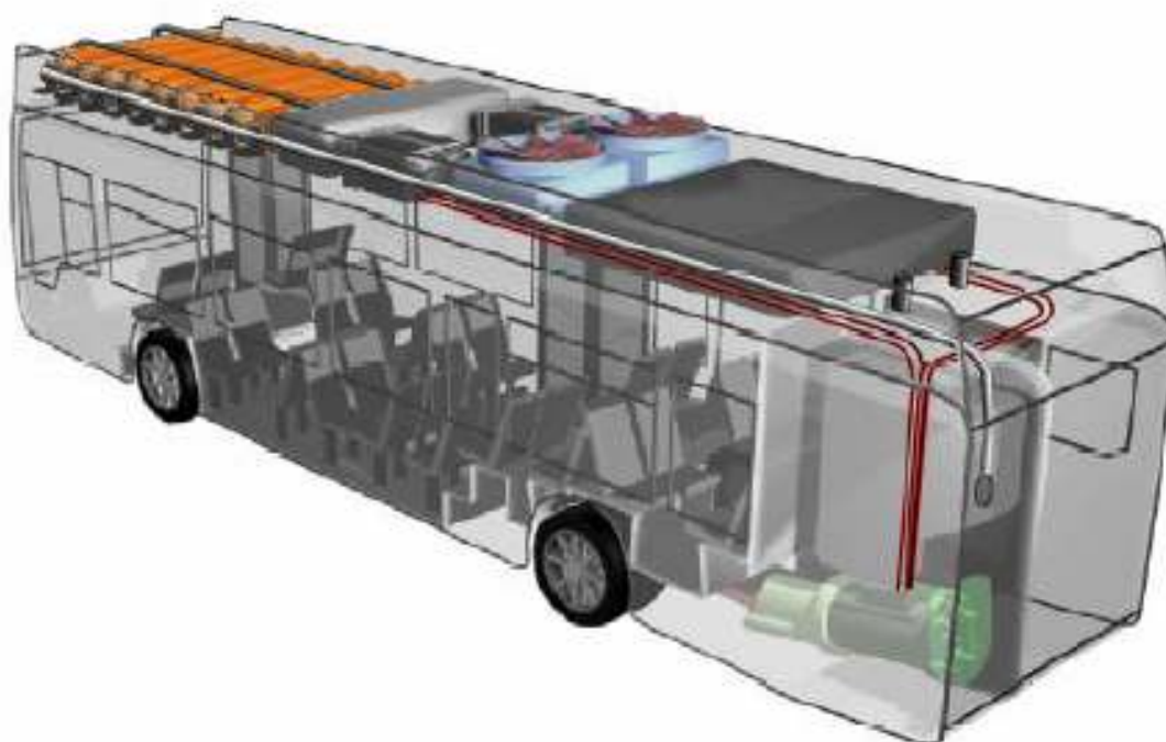
Figura 4.2 Diseño básico de un autobús con celdas de combustible.
