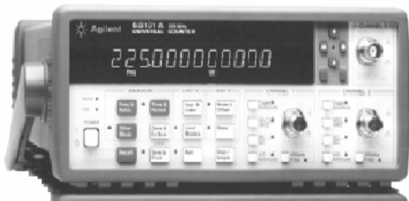
**Figura 3.1** Panel frontal del contador Agilent 53132A.
