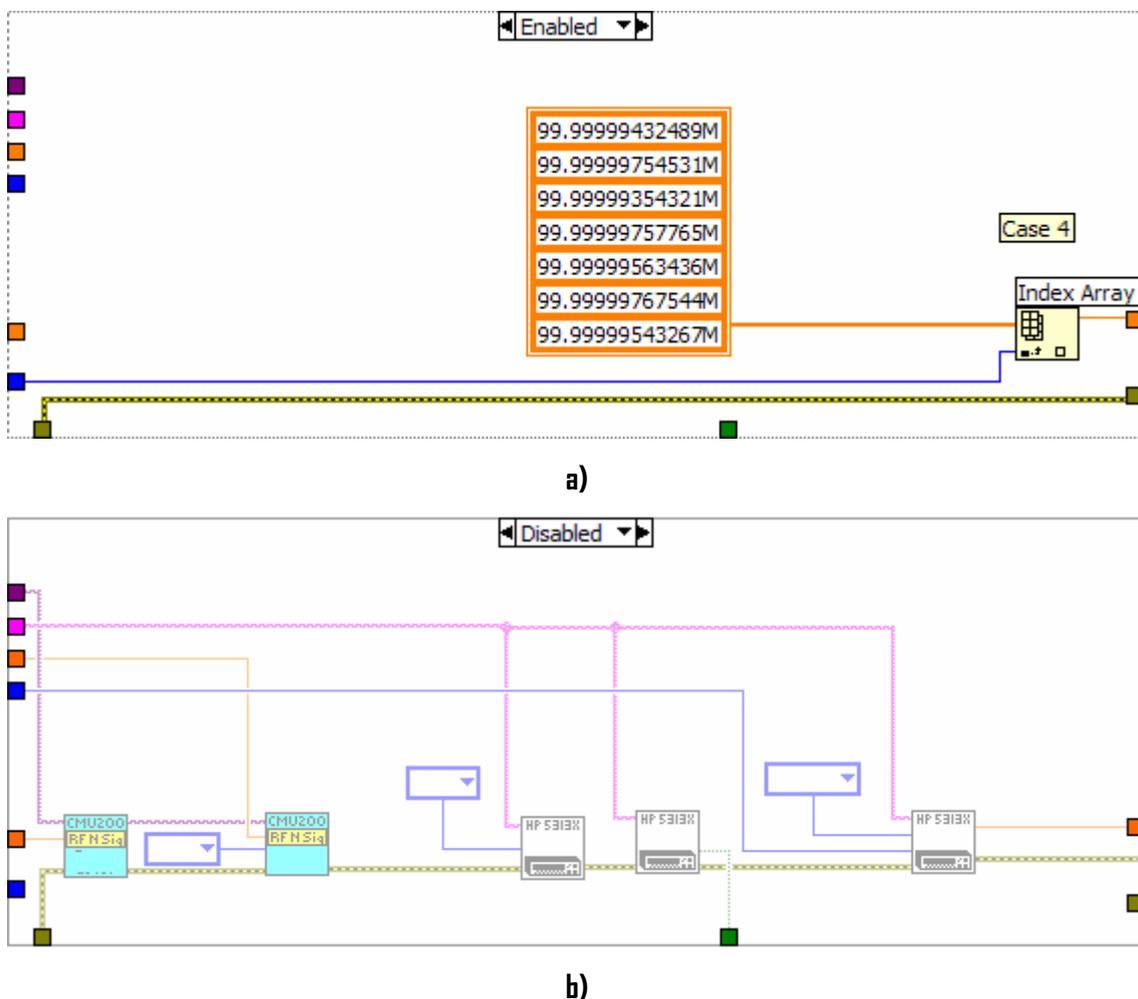
**Figura 5.12** Uso del Diagram Disable Structure. a) Diagrama para la simulación b) Diagrama para la implementación real.
