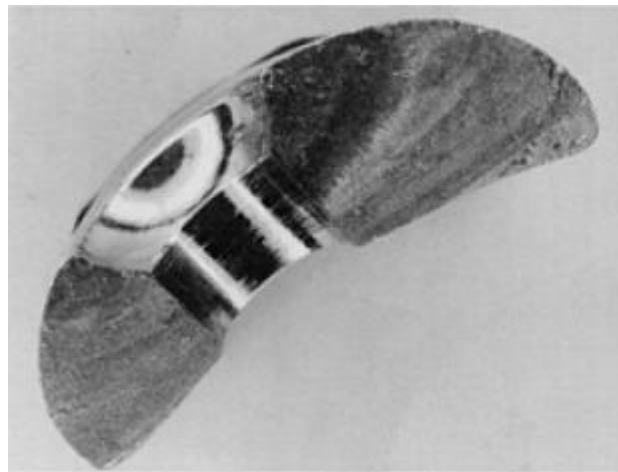
Figura 5.26(h). Fractura por fatiga por compresión del tornillo sobre el implante ortopédico. [20]
