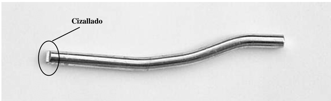
Figura 5.11 Imagen de la barra (VT2) de acero inoxidable 316L.
