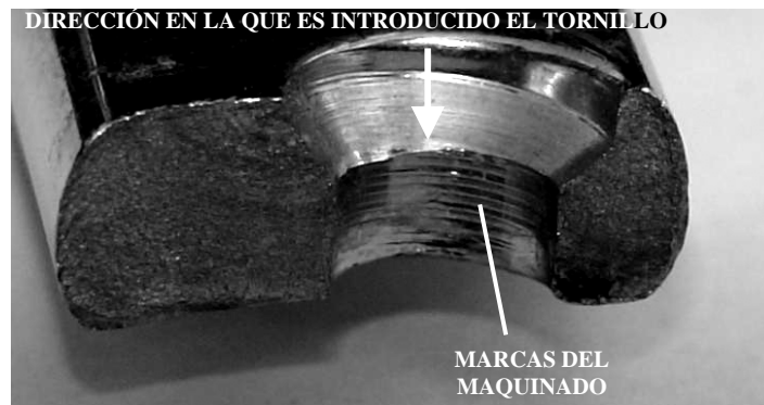
Figura 5.26(e). Imagen correspondiente a la fractura en la sección transversal de la placa 3. Muestra la dirección en que es introducido el tornillo de sujeción y marcas del maquinado.
