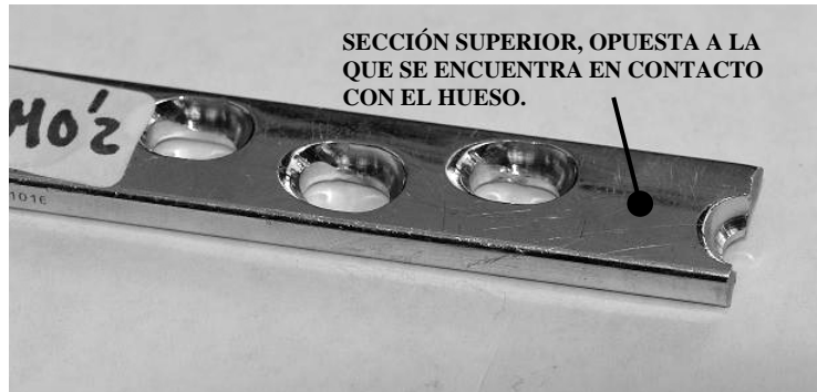
Figura 5.26(a). Imagen de la placa 1 que presenta fractura en el barrenado.
