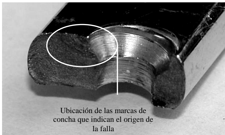
Figura 5.26 (f). Imagen correspondiente a la fractura en la sección transversal de la placa 3. Muestra pequeñas marcas de concha.
