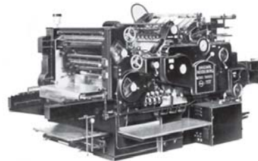
Modelo Heidelberg, moderna impresora rotativa y plana, de dos colores.
