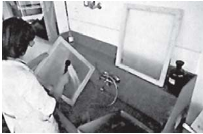
1. Preparación de la malla, para ser emulsionada.
