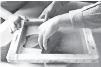
4. Impresión del diseño sobre el soporte deseado.
