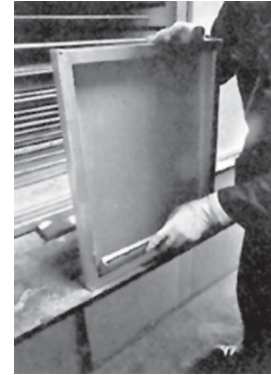
2. Emulsión de la malla, para colocar el positivo de la imagen a imprimir.
