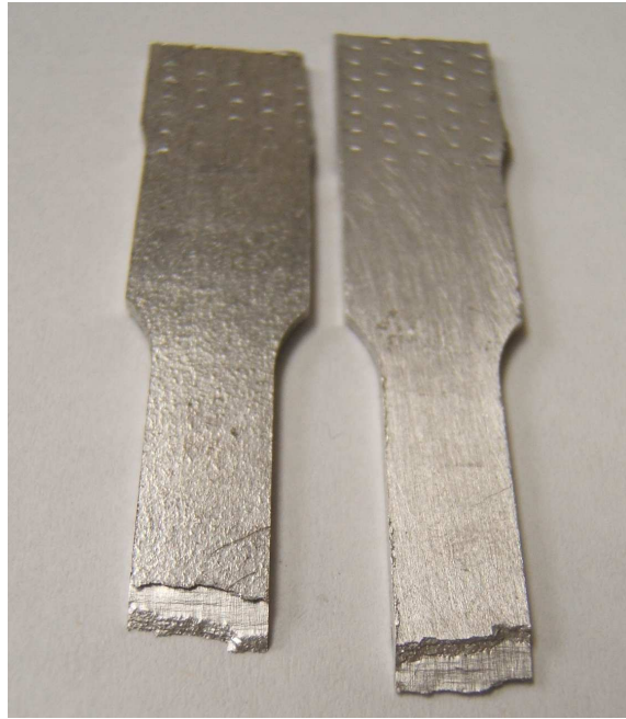
Figura 3.27: Fotografía de una probeta de tracción de 2 pasos de ARB, mostrando una fractura prematura.
