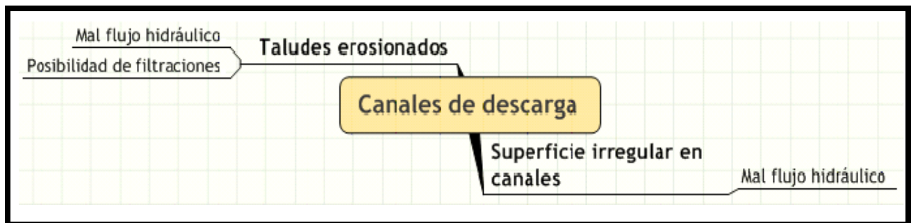
Figura 17. Principales problemas en canales de descarga.
