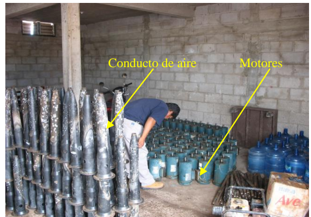
Figura 65. Aireadores de turbina.
