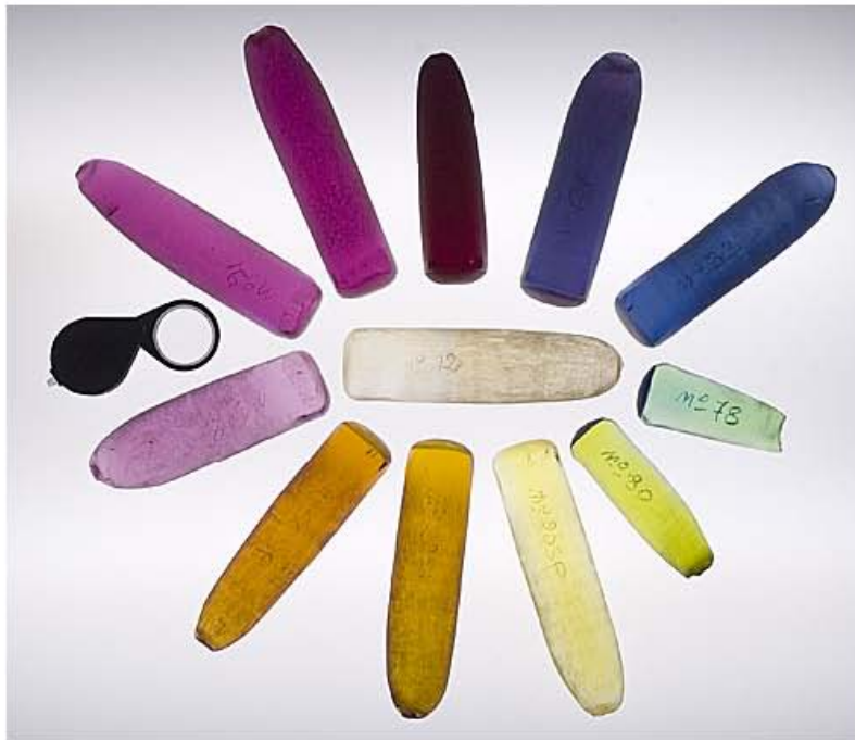
Foto de monocristales en forma de "bola" crecidos por método Verneuil, tomada de http://www.agta.org/gtc/20051004-verneuil-synthetic-corundum.html
