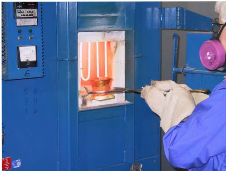
Judith Osmer saca un crisol de platino lleno de Flux fundido de la mufla. Tomada de http://www.ramaura.com/making.htm
