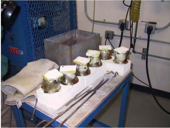
Crisoles enfriándose (izq). Removiendo el exceso de Flux ya sólido (der). Tomada de http://www.ramaura.com/making.htm
