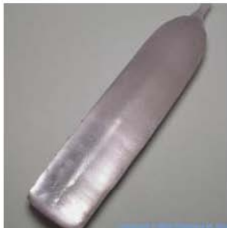
Cristal de Zafiro blanco obtenido mediante el proceso Verneuil. Tomada de www.theodoregray.com/.../SapphireBoule/s7s.JPG
