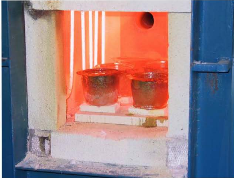
Mufla con crisoles a 1000°C. De la empresa productora de rubies: Ramaura. Tomada de http://www.ramaura.com/making.htm
