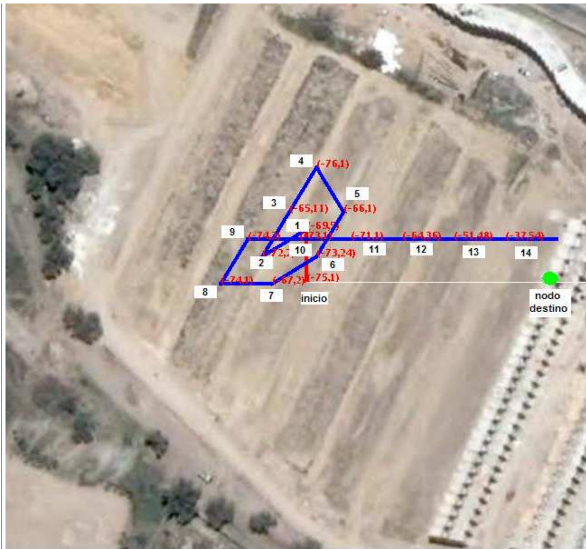
Figura 5.2.- Prueba de guiado con calidad de la señal en zona libre de obstáculos donde el destino se encontraba ubicado hacia el Este respecto a la orientación de inicio del nodo móvil
