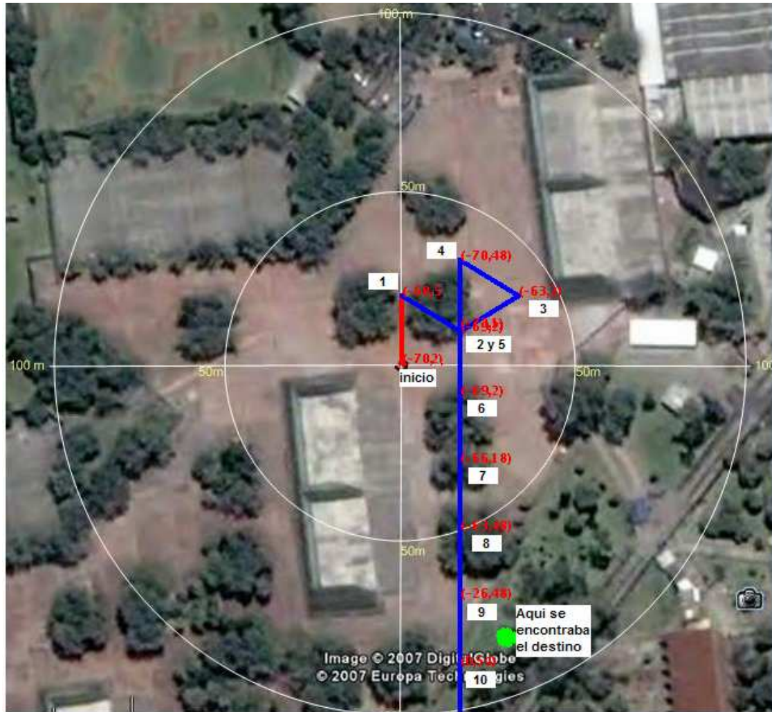
Figura 5.4.- Prueba de guiado con calidad de la señal correspondiente a zona con obstáculos donde el destino se encontraba ubicado al Sur de la orientación de inicio del nodo móvil
