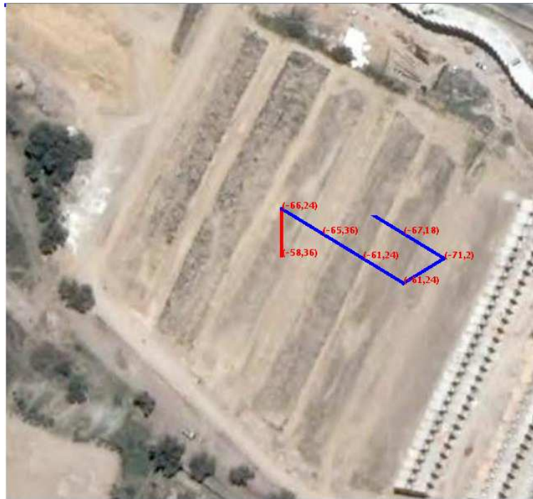
Figura 3.5.- Trayectoria dibujada por el sistema guía en un mapa precargado
