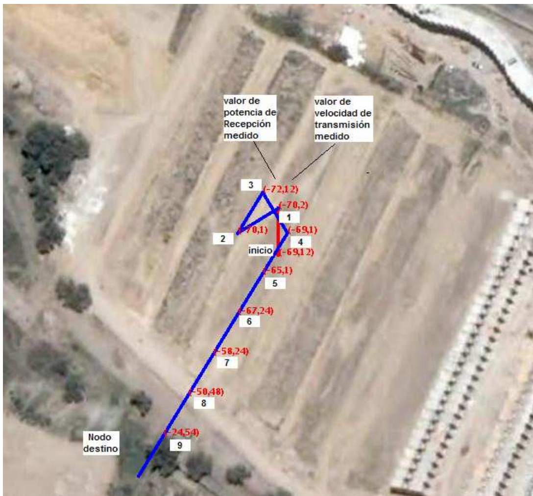
Figura 5.1.- Prueba de guiado con calidad de la señal en zona libre de obstáculos donde el destino se encontraba ubicado hacia el Sur respecto a la orientación de inicio del nodo móvil
