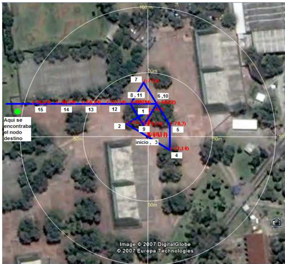
Figura 5.3.- Prueba de guiado con calidad de la señal correspondiente a zona con obstáculos donde el destino se encontraba ubicado al Oeste respecto a la orientación de inicio del nodo móvil
