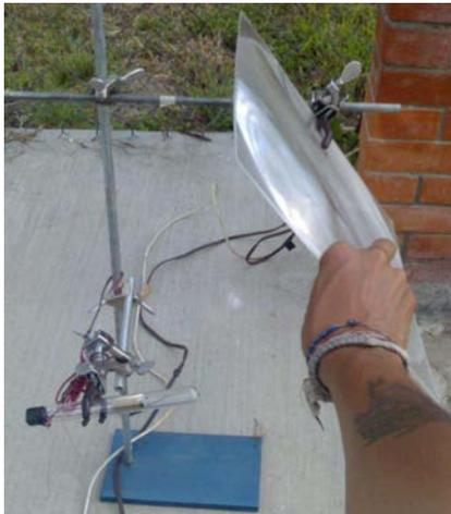
Figura 4.3. Primeras pruebas preliminares con la lente de Fresnel marca Edmund Scientific.
