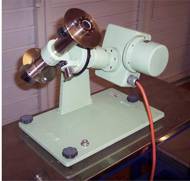
Figura 5.10. Pirheliómetro montado sobre seguidor solar eléctrico.
