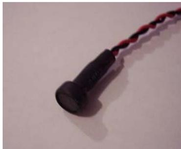
Figura 5.3. Pastilla del micrófono marca Steren modelo em-926.
