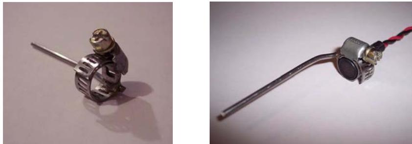
Figura 5.4. Soporte de la pastilla de micrófono marca Steren modelo em-926 para el extremo abierto.
