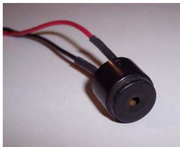
Figura 5.1. Micrófono marca Sharp.
