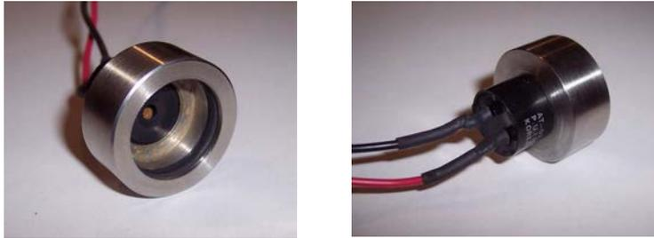
Figura 5.2. Micrófono marca Sharp acoplado al soporte que sella el extremo cerrado.
