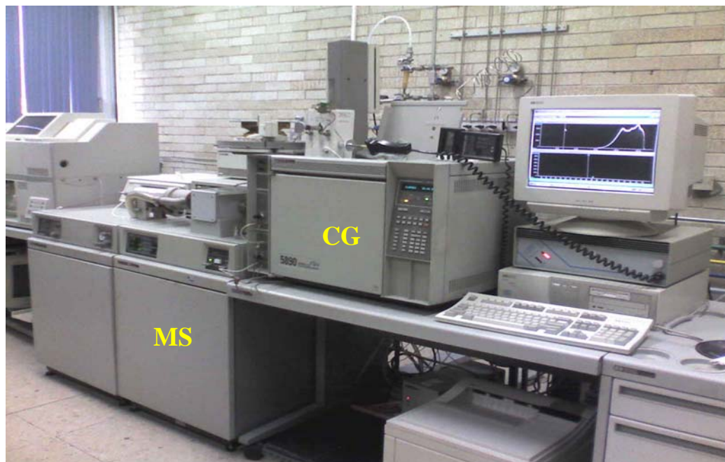
Figura 3.4. Sistema acoplado de análisis de cromatografía de gases-espectrometría de masas del laboratorio de Química de plasmas y estudios planetarios del Instituto de Ciencias Nucleares (UNAM).
