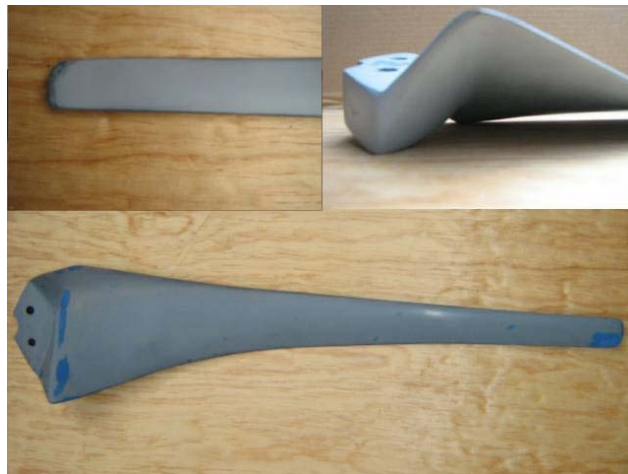
Figura 3.13. Pala final en fibra de vidrio y resina epóxica.
