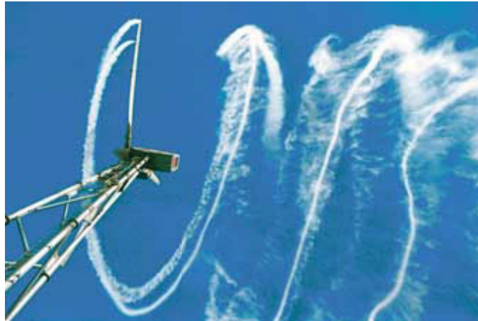
Figura 2.4. Estela producida por un rotor eólico monopala.
