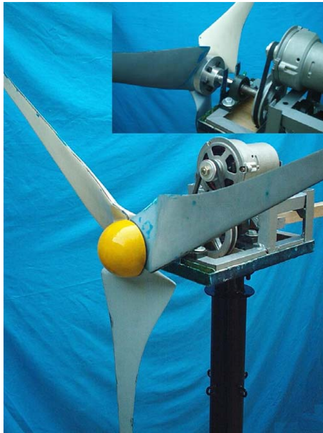
Figura 4.10. Ensamble del rotor con la nariz en la flecha. Arriba, se muestra el detalle del ensamble en una vista posterior.
