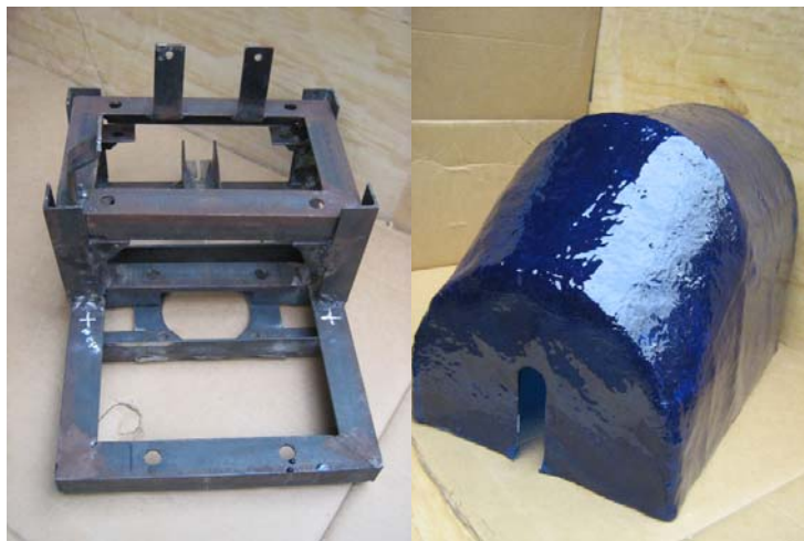
Figura 3.16. Construcción de la estructura y cubierta de la góndola.
