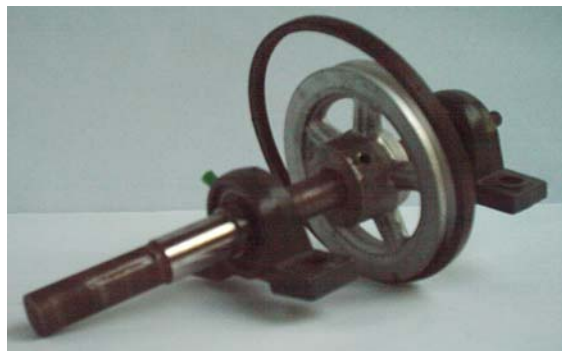
Figura 4.2. Montaje de chumaceras y polea en la flecha
