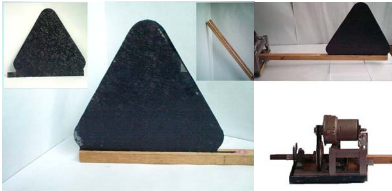
Figura 4.5. Ensamble de la veleta en la ranura.
