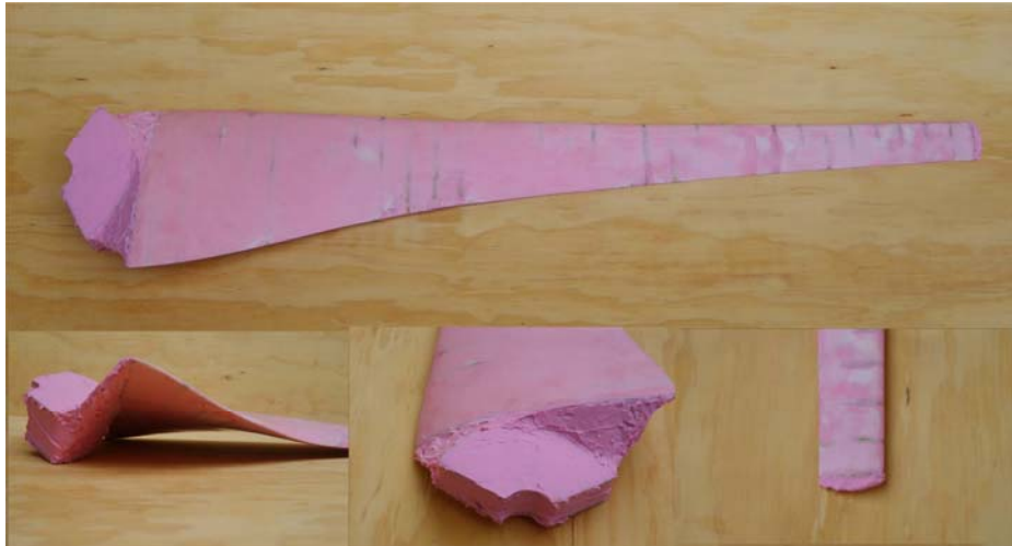
Figura 3.12. Forma final de la pala. Arriba, pala completa. Abajo, forma de la base y de la punta de la pala.
