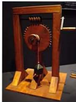
Fig. 4.18 Engranaje helicoidal de Leonardo.
