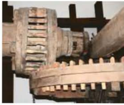
Fig. 4.17 Engranajes helicoidales de madera.
