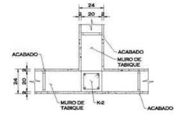
DETALLE TIPO UBICACION CASTILLO EN MURO
