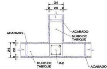
DETALLE TIPO UBICACION CASTILLO EN MURO
