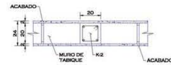
DETALLE TIPO UBICACION CASTILLO EN MURO
