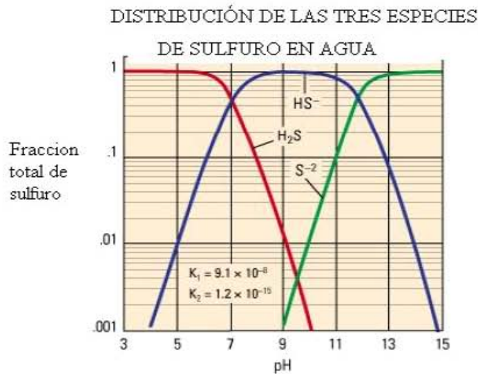
Figura 1.3- Distribución de las diferentes especies de sulfuro en agua dependiendo del pH.
