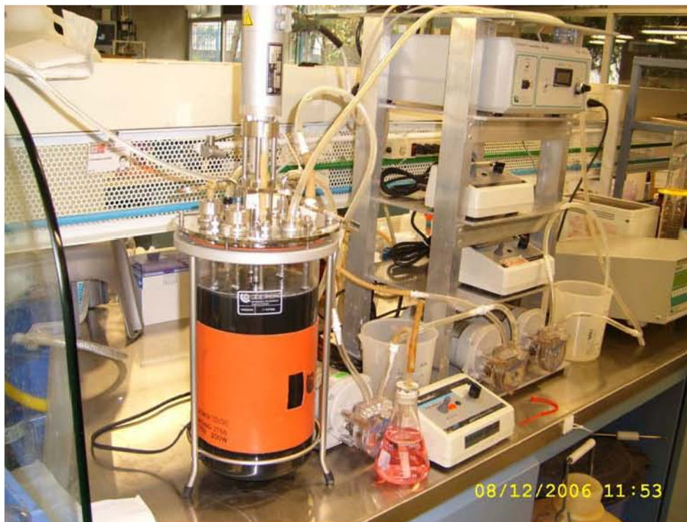
Figura 5.3. Reactor sulfato-reductor biomasa suspendida.
