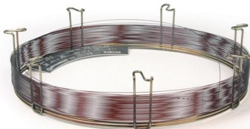
**La Figura 3.4.2.2.** Las columnas capilares son de sílice fundido-(vidrio purificado de silicato) capilar (normalmente 10-100 m de longitud y 250  $\mu$  m de diámetro interior), que ha revestido la fase estacionaria en la superficie interior. Las columnas capilares proporcionar mucho mayor eficiencia de separación de las columnas empaquetadas, pero son más fáciles de sobrecarga por el exceso de muestra.
