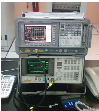
Figura 3.9 Analizadores de espectros utilizados para realizar las pruebas de aislamiento.
