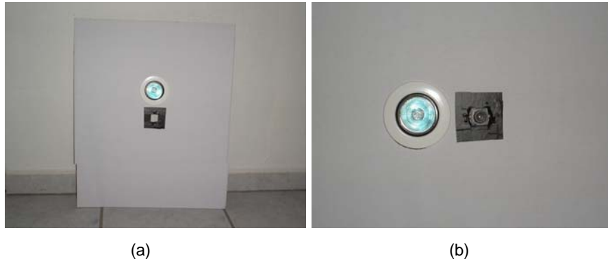
Fig. 4.6(a) Vista de lejos de la tapa del contenedor, (b) Lámpara y webcam montadas en la tapa 6
