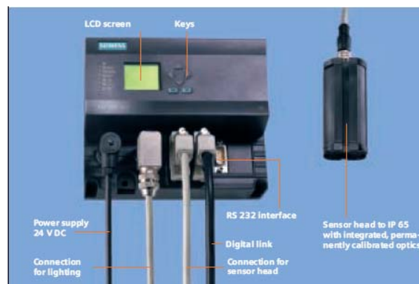
Fig. 1.11 Hardware del sistema Pro-Vision de Siemens 11
