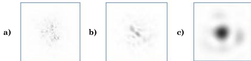
Fig. 2.9 Imágenes invertidas de corta exposición de una estrella tomada con telescopios de diámetros distintos: a) 20r_0 b) 7r_0 c) 2r_0
