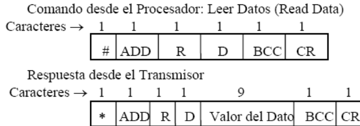
Figura 1a. Formatos Comandos/Respuestas en el protocolo ASCII
