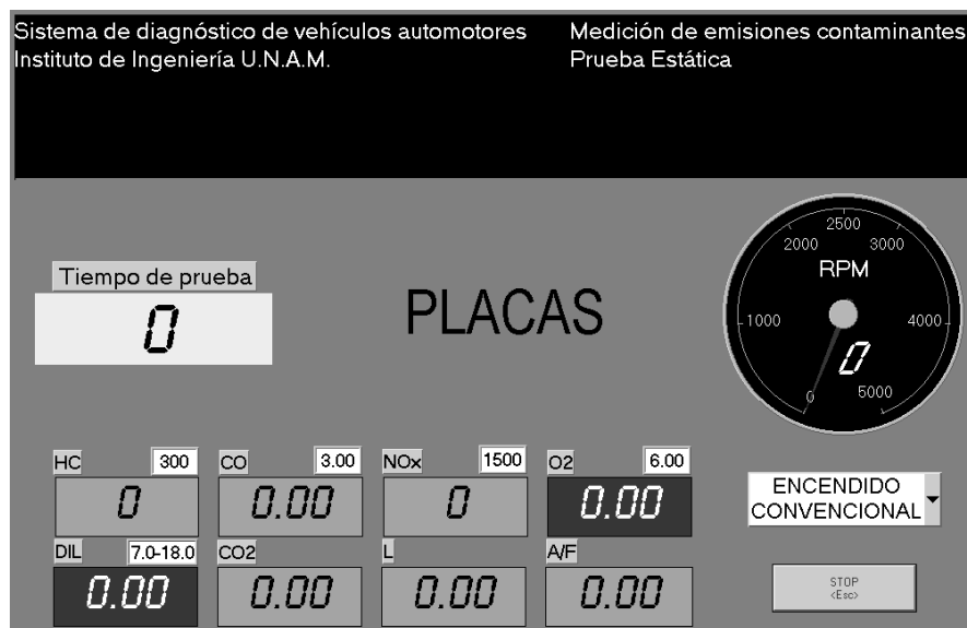
Figura 2.24. Prueba estática de medición de gases.
