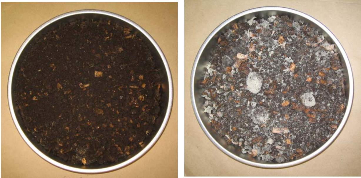
a) b) Figura 4-12. Imágenes del empaque de biofiltración-composta operada a largo plazo. a) Previo al proceso de transformación de H 2 S (Tiempo=0 días). b) Posterior al proceso de transformación de H 2 S (Tiempo=28 días).
