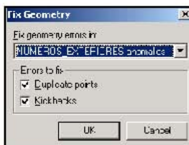
Figura 5.5 Corrección de geometrías anómalas, puede que otros errores no puedan corregirse automáticamente y necesitan de la intervención del usuario.
