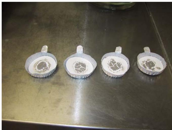
*Figura 4.12 Análisis de sólidos suspendidos según técnica del APHA*
