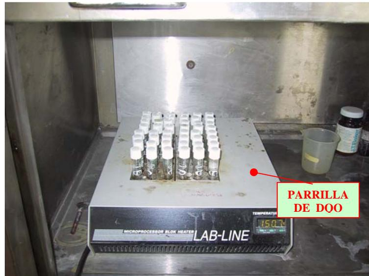
*Figura 4.10 Análisis de DQO según la técnica de dicromato de potasio*
