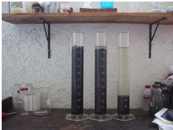
*Figura 4.14 Prueba de sólidos sedimentables.*
