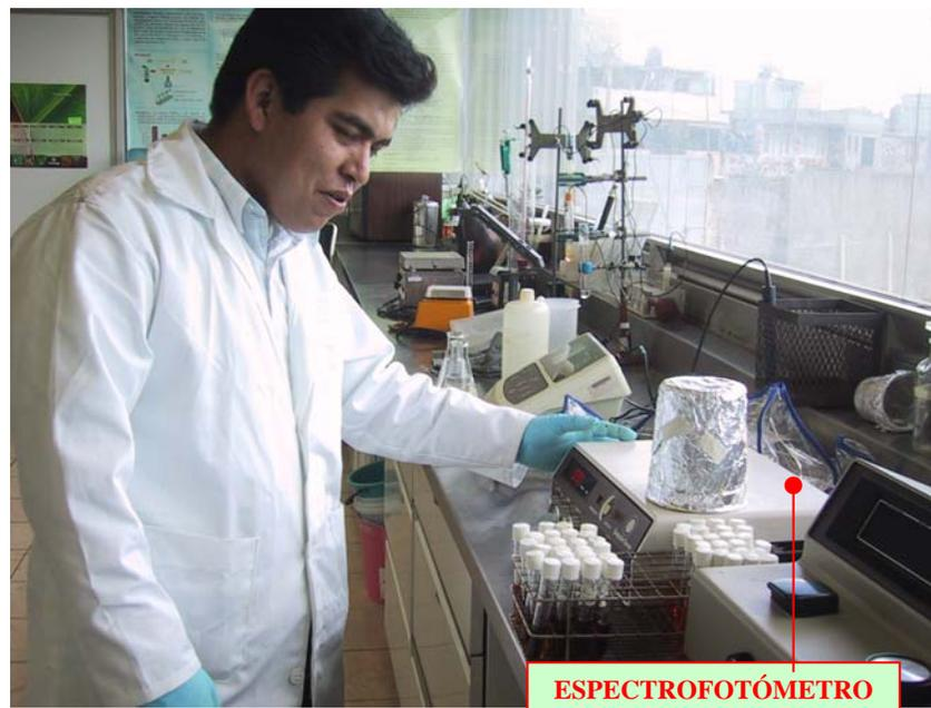
*Figura 4.11 Lectura de las muestras en el espectrofotómetro*
