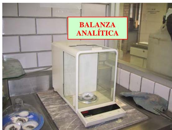
*Figura 4.13 Análisis de sólidos suspendidos según técnica del APHA*
