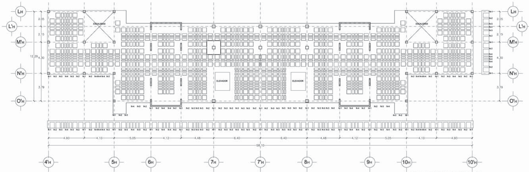
LOSA ENCASOTONADA NIVEL + 8.55
