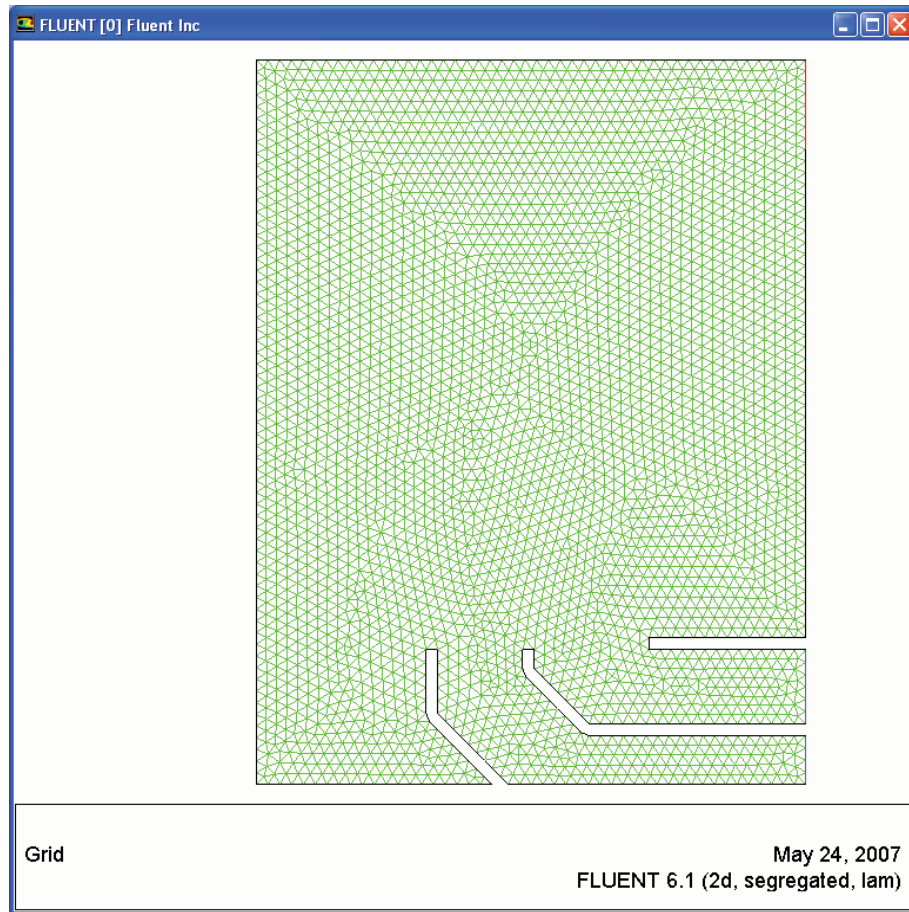
Figura 4.6. Mallado de la geometría con elementos triangulares realizado en Gambit 2.1 .
