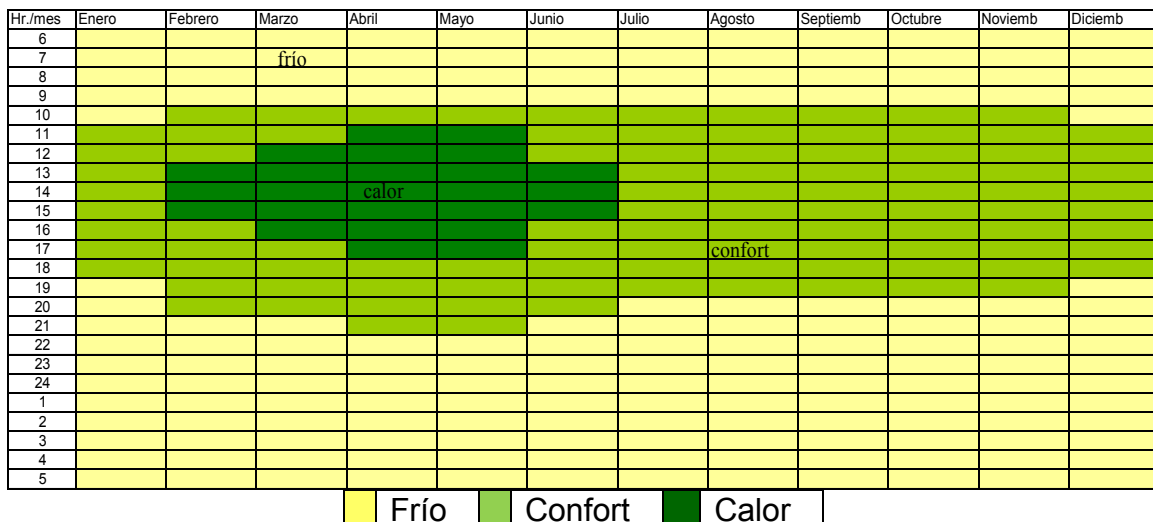
Gráfica 2.5. Condiciones o sensaciones térmicas en el bioclima templado-húmedo (Caso: Ciudad de Cuernavaca).
