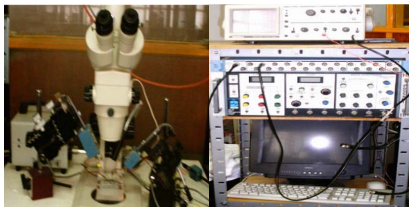
Figura 2.3: Equipo empleado en el estudio electrofisiológico del canal TASK-3 de rata. A la izquierda, microscopio, cámara de perfusión y micro manipuladores. A la derecha, osciloscopio, interfase, amplificador y software.
