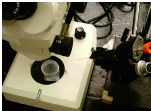
Figura 2.2: Equipo utilizado en la inyección de RNAm de TASK-3 en ovocitos de X. laevis .
