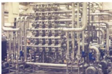
Fig. 6.3 Proceso de Ósmosis Inversa.
