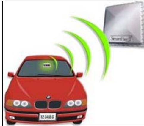
**Figura 5.7 Tarjeta sobre el cristal del automóvil**
