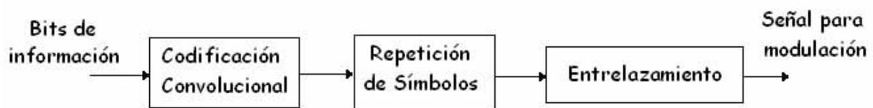
Figura A1.1 Proceso de codificación de canal
