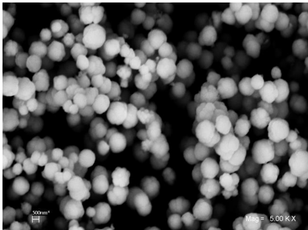
FIG. B-22 Nanopartículas esféricas de BaSO 4 sintetizadas en medio orgánico (DMSO) (5Kx).
