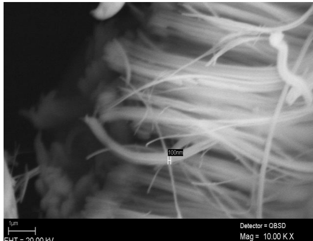
FIG. B-16 BaSO 4 sintetizadas. Medio acuoso-poliacrilato de sodio. pH=7 (10Kx).
