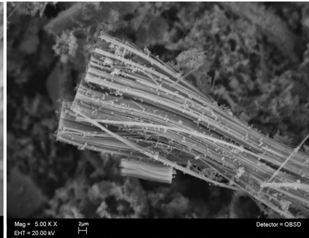
FIG. B-17 BaSO 4 sintetizadas. Medio acuoso-poliacrilato de sodio. pH=8. T. amb (5Kx).
