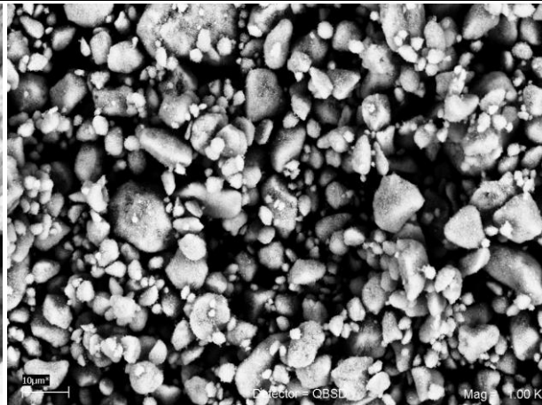
FIG. B-8 Nanopartículas \text{BaSO}_4 comercial, Sachtleben Chemie Germany (1Kx).
