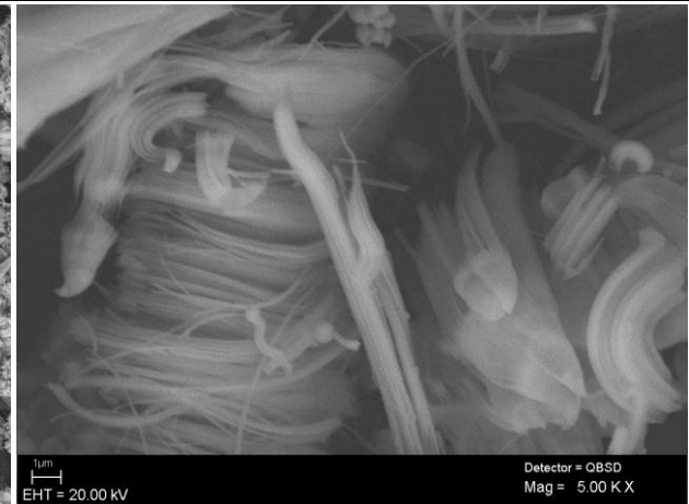
FIG. B-15 BaSO 4 sintetizadas/poliacrilato de sodio. pH=7. 8 días de crecimiento (5Kx).
