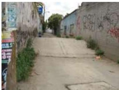
Figura 4.44 a La construcción de topes es lo más común para evitar inundaciones, sin embargo en este caso, ya varias veces se ha rebasado su nivel.
