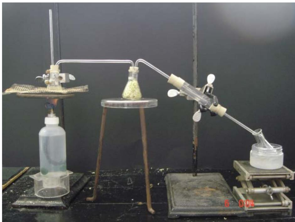
Fotografía No. 13. Extracción por arrastre de vapor de la esencia del anís estrella
