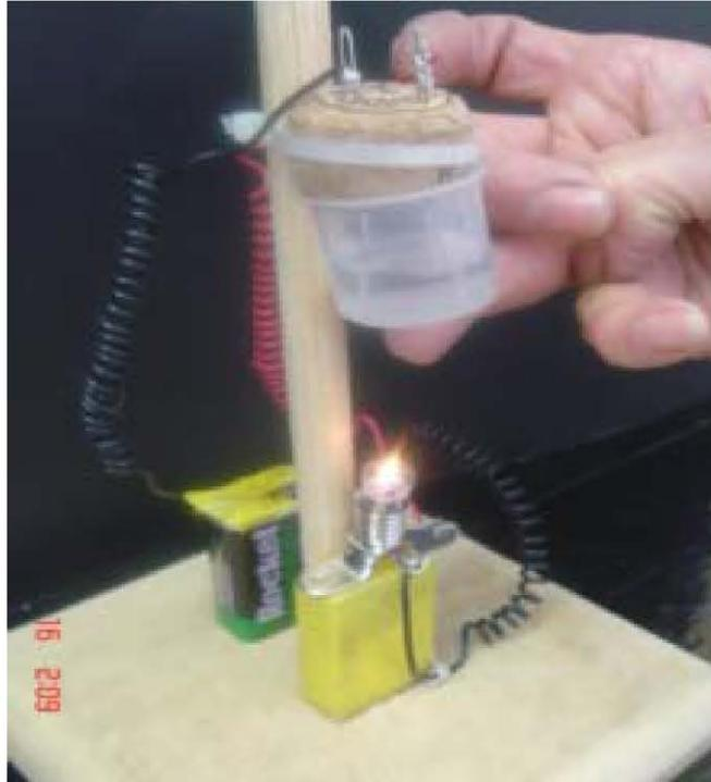
Fotografía No. 22. Solución electrolítica fuerte. Condujo la corriente eléctrica, prendió el foco.
