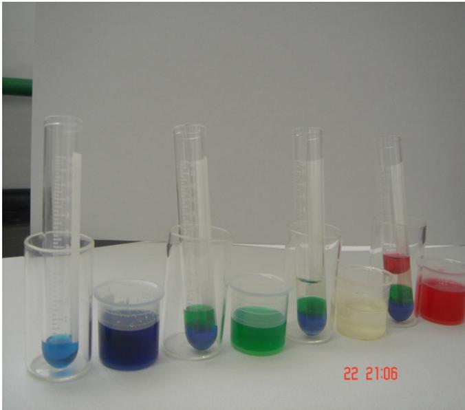
Fotografía No. 9. las sustancias se van agregando con la secuencia indicada y por las paredes, de acuerdo a la diferencia de densidades, las sustancias se separan en fases.
