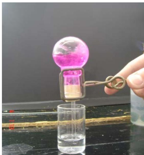
Fotografía No. 33. Formación de la “fuente” debido al vacío que se forma en el matraz.
