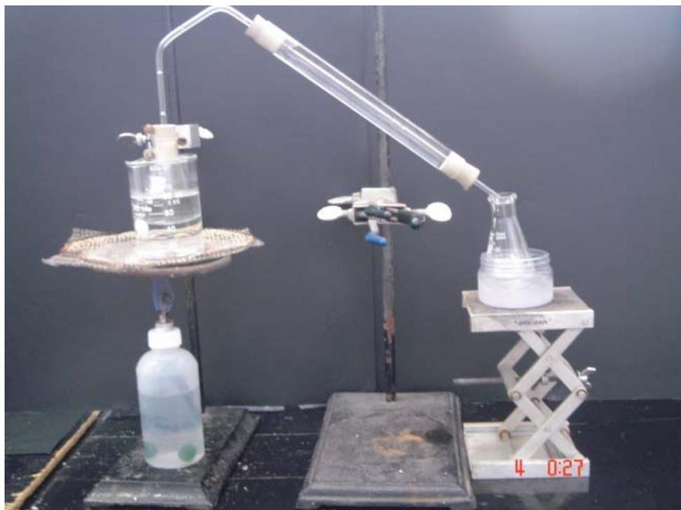
Fotografía No. 15 Microsistema de destilación para la extracción del aceite de almendras dulces
