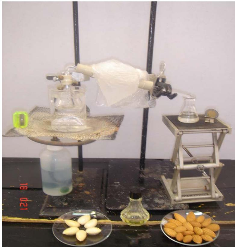
Foto No. 17. Montaje (con enfriador de bolsa de hielo que ahorra agua) para el mismo proceso de la separación del aceite de almendras.
