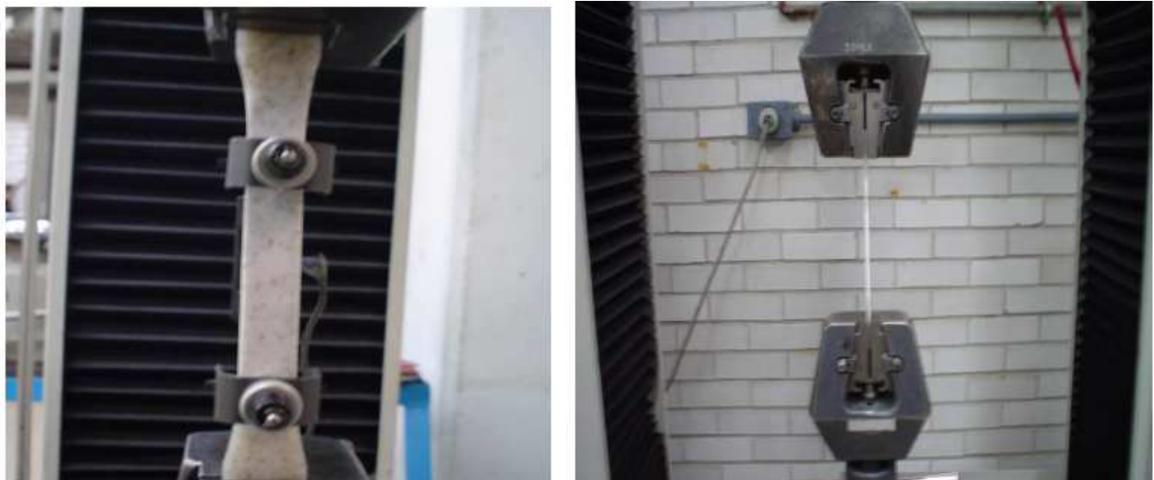
Figuras 3.18 a y b. Desarrollo del Ensayo de Tracción.
