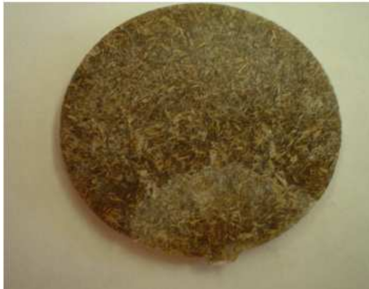
Figura 4.1. Muestra dañada por la variación de temperaturas.
