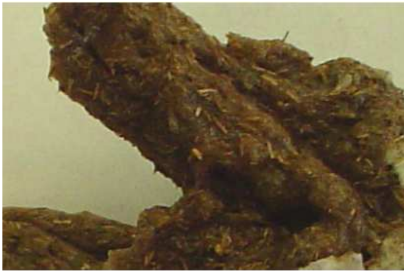
Figura 4.7. Muestra con desprendimiento de fibras de la matriz.
