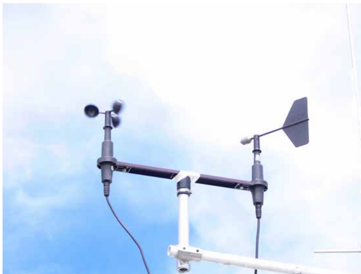
Figura A.1. Anemómetro y veleta.
