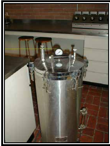
Figura 2.29 esterilización de material en “autoclave” o “estufa”
