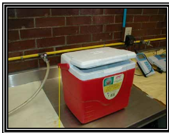
Figura 2.34 recipiente para transporte de muestras a el laboratorio
