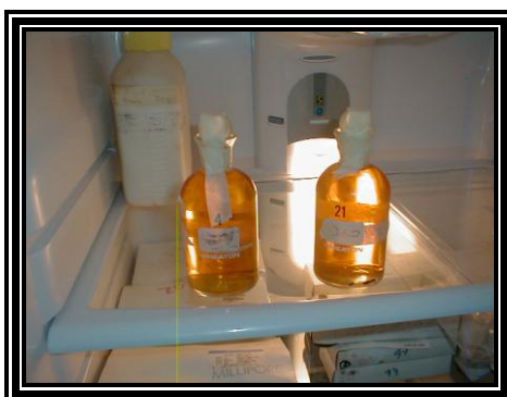
Figura 2.40 fijación del oxígeno disuelto en las muestras
