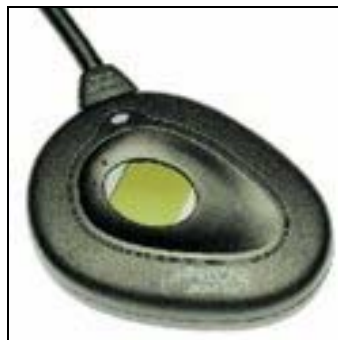
Figura 1.5.3. Ejemplo de un lector capacitivo
