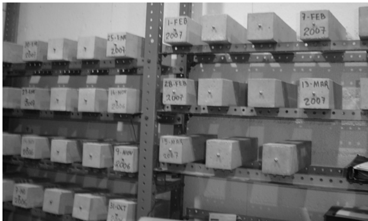
Fig. 4.13 Almacenaje de las barras de contracción por secado en la cámara seca.
