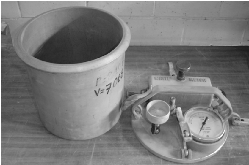
Fig. 4.3 Equipo para medir el peso volumétrico y el contenido de aire
