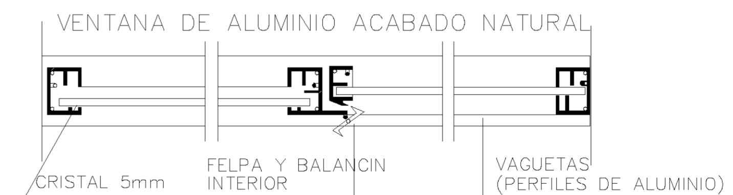
SECCION HORIZONTAL (Para ventanas batientes)
