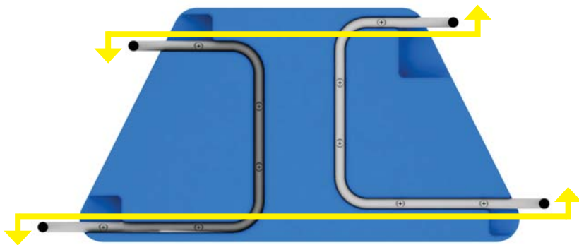
↑ Las patas están desfasadas en el sentido horizontal 7/8 "
