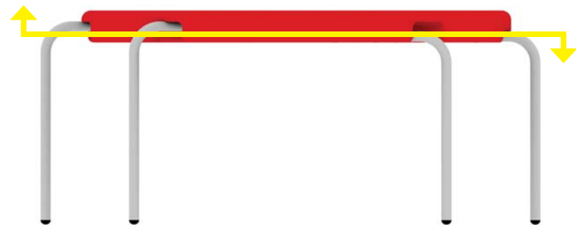
↑ Las patas están desfasadas en el sentido vertical 7/8 "
