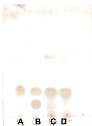
Figura 7.17. CCF de los productos de hidrólisis enzimática de la hidroxiquinona acetilada. Revelador ácido sulfúrico. A: Estándar de hidroxiquimona acetilada, Rf= 0.33; B: Control positivo Candida antarctica , Rf= 0.177; C: Rxn la lipasa de Bacillus pumilus GMA1, Rf= 0.172; D: Blanco, Rf= 0.33.
