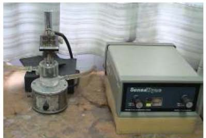
Figura 6.12. Equipo de presión máxima de burbuja
