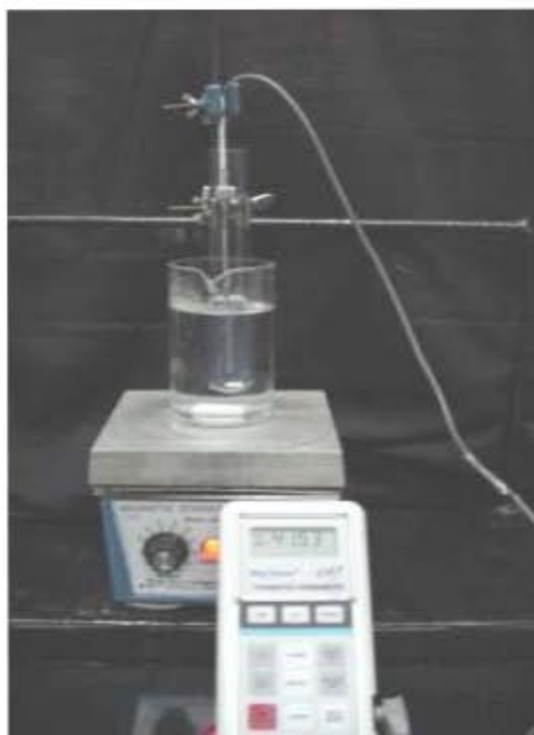
Figura 6.2. Equipo para medir Punto de Enturbiamiento
