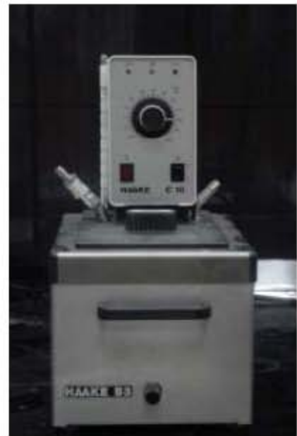
Figura 6.7. Baño para control de temperatura
