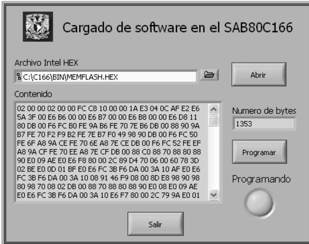
Figura 3.18: Interfaz en LabVIEW para cargar un programa en el SAB80C166.
